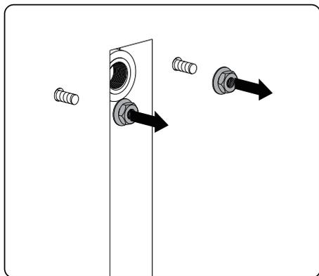
Снимите гайки и металлические шайбы с анкера и отложите их для последующего использования.
