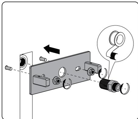
Используя снятые ранее гайки и шайбы закрепите монтажное основание на стене. Оберните адаптер G1/2 на G3/8 со стороны G1/2 тефлоновой лентой и с помощью гаечного ключа закрутите его в трубу в стене. Обязательно проверьте соединения на наличие утечек.
