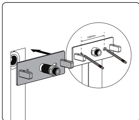
Используйте монтажное основание и адаптер в качестве шаблона, с помощью карандаша наметьте места для двух монтажных отверстий, где необходимо сверление.
