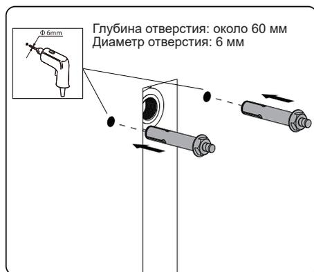
Просверлите отверстия в намеченных местах диаметром  $\varnothing$  6 мм и глубиной 60 мм. Вставьте металлические анкеры в отверстия.
