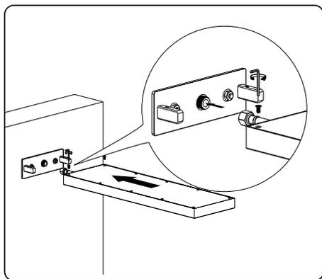
Подсоедините шланги корпуса душа к стороне G3/8 адаптера, затем установите корпус душа на монтажное основание и затяните его, входящим в комплект шестигранным ключом.
