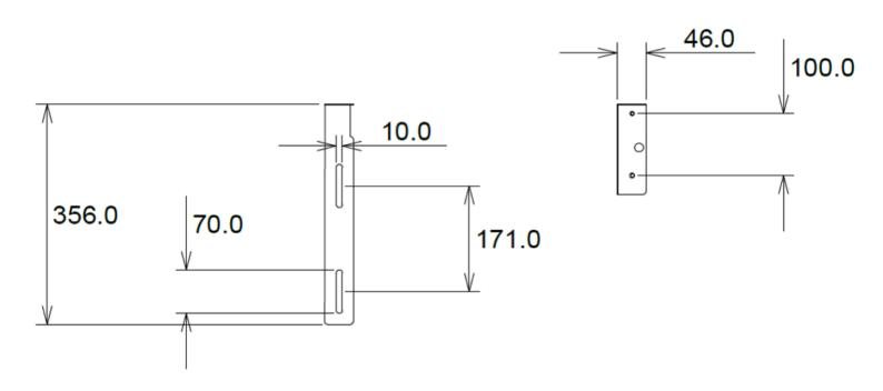
Габаритный чертеж сифонного узла
