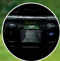
ИК-датчик приближения рук Чувствительность регулируется потенциометром.
