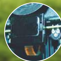
ИК-датчик приближения рук Чувствительность регулируется потенциометром.
