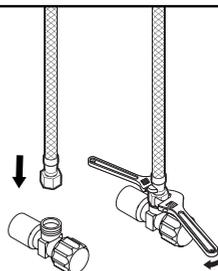
Подключите гибкую подводку к системе водоснабжения с помощью двух регулируемых ключей (избегайте скручивания или перекручивания подводки). Включите воду и проверьте соединения на герметичность.
