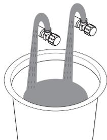
Перекройте воду в системе водоснабжения. Очистите крепежные элементы и поверхности. Замечание: при первичной установке включите воду и дайте воде свободно течь в течение 60 секунд. Затем отключите воду.
