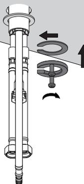
Закрепите смеситель снизу под рабочей поверхностью, используя входящий в набор комплект крепежа.
