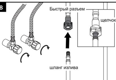
Перекройте подачу воды. Проталкивайте гибкий шланг излива в быстрый разъем до тех пор, пока не услышите звук щелчка. Убедитесь, что шланг надежно закреплен в раземе.
