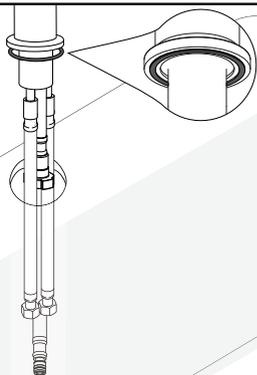
Установите уплотнительное кольцо в нижней части смесителя, затем вставьте смеситель в отверстие на крепежной поверхности, пропустив гибкую подводку в отверстие.
