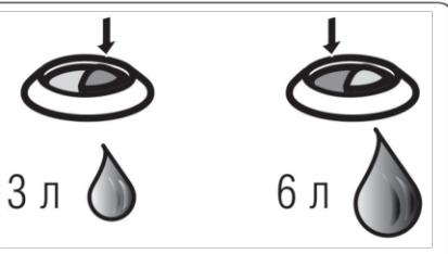
Механизм смыва имеет 2 режима спуска воды. Большая кнопка на нажимной кнопке (1) спускает весь объём воды. Маленькая кнопка только половину объёма воды.
