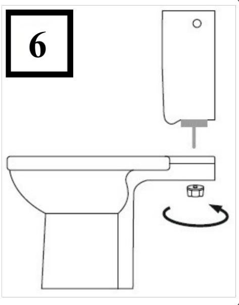
6. Снизу полки унитаза на выступающую резьбовую часть винта наденьте резиновое уплотнение, шайбу, потом пластиковую гайку и затяните.
