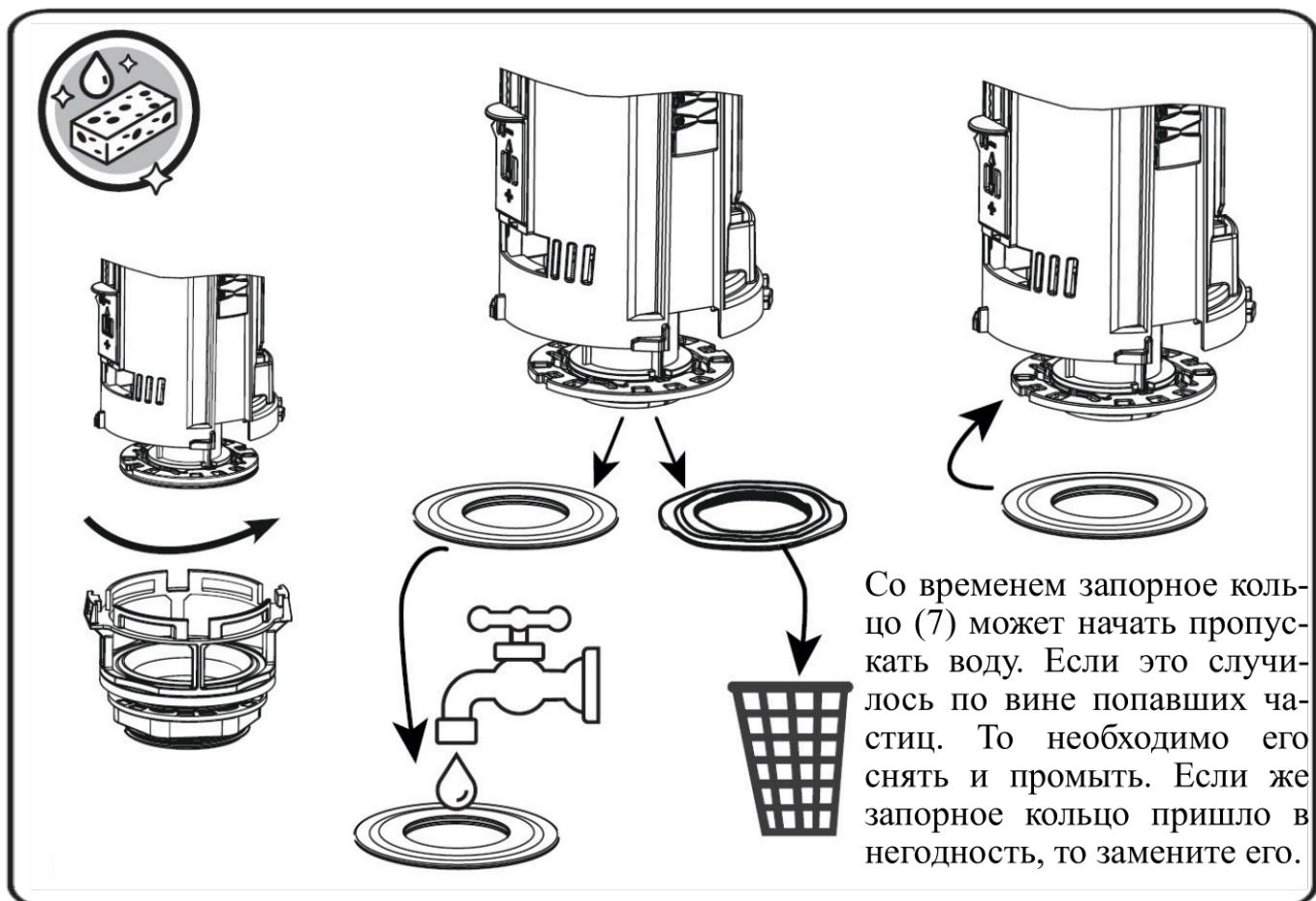
\* Наливной механизм является не обслуживаемым, поэтому необходимо использовать фильтра для очистки воды в водопроводе.
