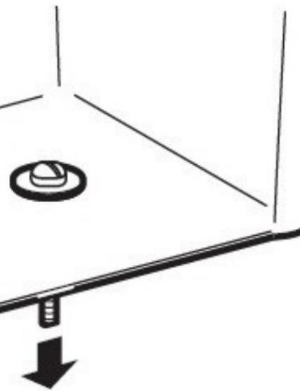
3. Установите в бачок крепления в следующем порядке: вставьте винт в отверстие шайбы, затем наденьте на винт резиновое уплотнение конусом вниз и вставьте в отверстие бачка. Снизу бачка на выступающую резьбовую часть винта наденьте резиновое уплотнение, потом шайбу, а затем оденьте гайку и затяните для полной герметичности соединения.
