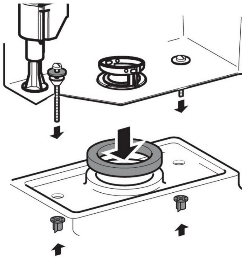
\* В некоторых моделях унитазов прежде, чем устанавливать бачок. Требуется сначала подключить гибкий шланг к механизму налива.
