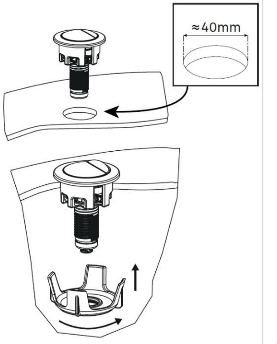
10. Вставьте нажимную кнопку (1) в отверстие в крышке наливного бачка для унитаза.
