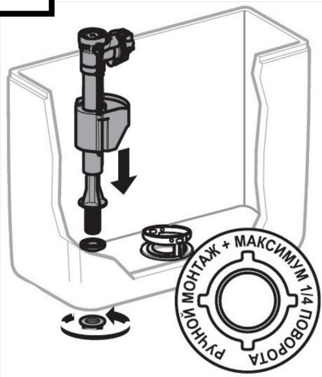
4. Поместите наливной механизм в среднее отверстие бачка. Убедитесь, что резиновая прокладка (16) расположена между бачком и наливным механизмом. Снизу бачка наденьте на резьбу (17) наливного механизма уплотнение (18) и далее оденьте и затяните пластиковую зажимную гайку (19) с наружной стороны бачка.
