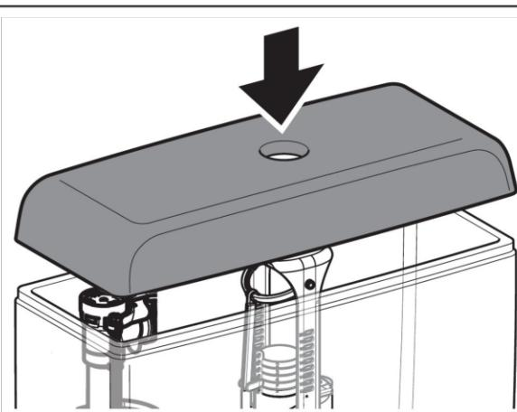
12. Установите крышку бачка на наливной бачок.
