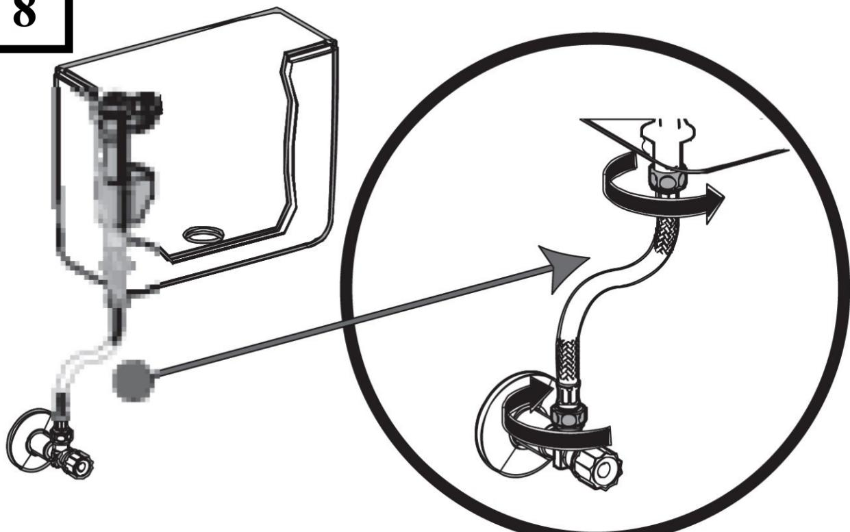
8. Подключите наливной механизм к холодной воде через запорный вентиль и откройте подачу воды.
