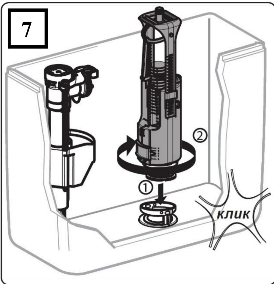
7. Вставьте корпус (5) смывного механизма в корзину клапана (12) и проверните до характерного щелчка.
